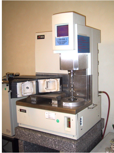
Figure B.10. : Rhéomètre ARES à déformation imposée.
