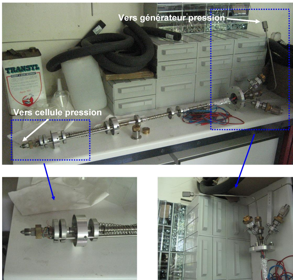
FIG. B.5 – Canne pression pour cryostat
