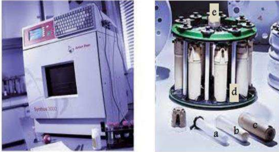
Figure II-2 : Illustration du four à micro-ondes utilisé et ses équipements (Ait-Atmane 2012).
