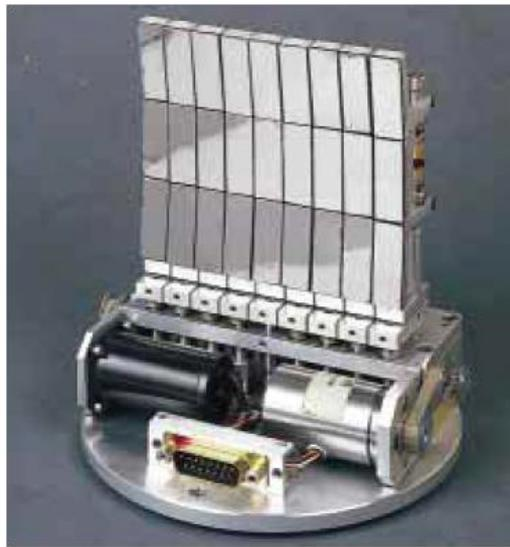
**Fig.2.4** : Analyseur graphite PG002 disponible sur le spectromètre 2T (LLB). Il est constitué de 27 lames de surface 3.5 x 2.5 cm. L'ensemble du montage peut être courbé horizontalement et/ou verticalement permettant ainsi la focalisation du faisceau de neutrons.
