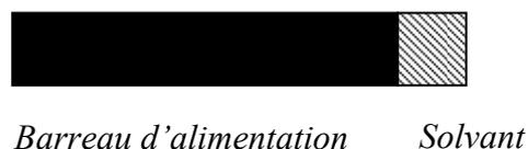
Fig. 3.11 : Représentation schématique du solvant thermocollé sur le barreau d'alimentation
