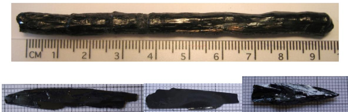
**Fig. 3.13** : a) Gangue polycristalline obtenue à la fin d'une croissance par la technique TSFZ. b) Trois monocristaux extraits de cette gangue.
