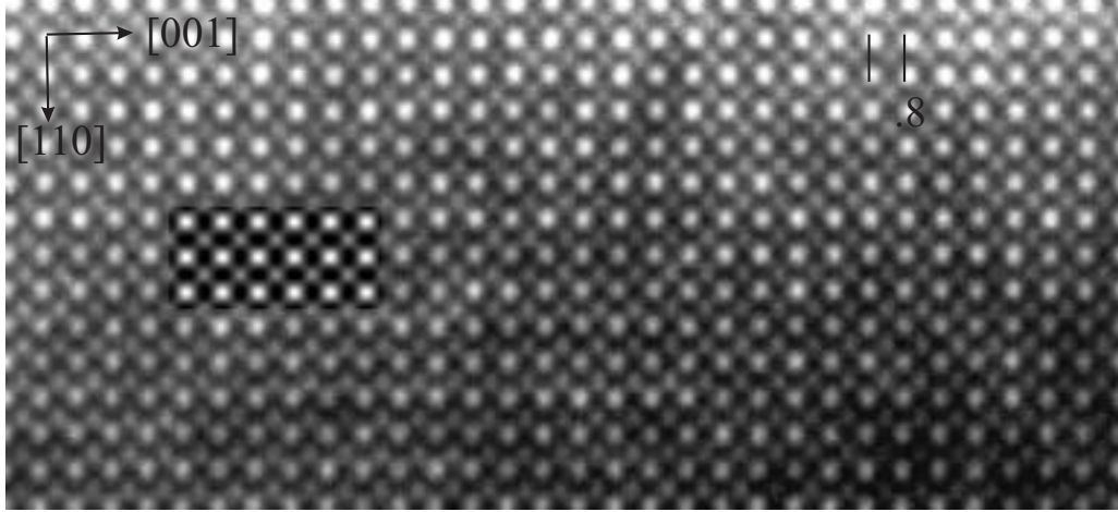
FIG. 3.15 – Image haute résolution orientée selon [\bar{1}10] et à gauche simulation pour une valeur de défocalisation de -800 \text{ \AA} du composé \text{Pr}_{0.5}\text{Sr}_{0.1}\text{Ba}_{0.4}\text{MnO}_3 à température ambiante.
