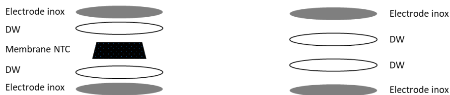
Figure 80. Schéma du système électrochimique à deux électrodes bloquantes d'inox séparées par un sandwich DW-NTC-DW ou seulement par 2 épaisseurs de DW.
