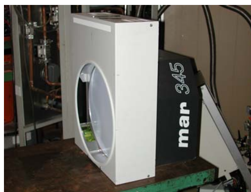
Figure IV.1 : Vue générale du spectromètre. Les neutrons venant de gauche, en passant par le monochromateur et le collimateur, puis ils entrent dans le tube de vol, pour être détectés par le MAR.
