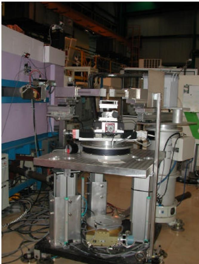
**Figure 6.3** : La nouvelle base porte-échantillon
