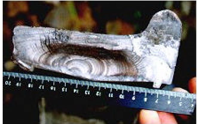
**Figure 5.8 :** Surface de rupture d'une roue accidentée
